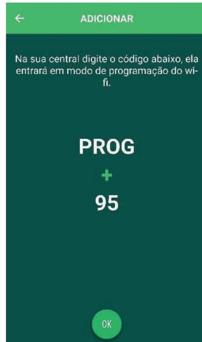
**2º passo:** Será necessário digitar na central de alarme o comando **PROG + 95**, para que a central entre no modo configuração da **Wi-Fi** por 30 segundos, e pressione **OK**.
